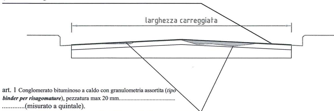
art. 1 Conglomerato bituminoso a caldo con granulometria assortita (*tipo binder per risagomature*), pezzatura max 20 mm.....
