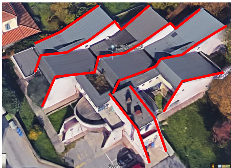
Figura 1 Pareti che non sono dotate di controventatura
