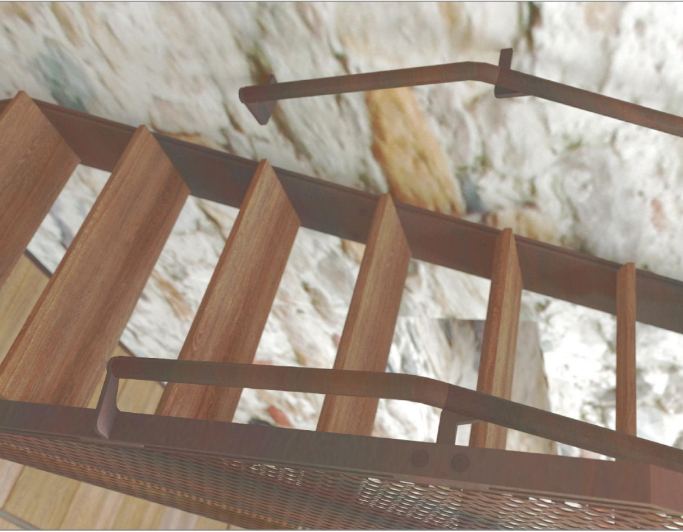
Dettaglio 1 - Snodo corrimano tra rampe ortogonali
