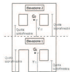
Fig. 1 - Esempio di rappresentazione schematica della parete ribaltante
