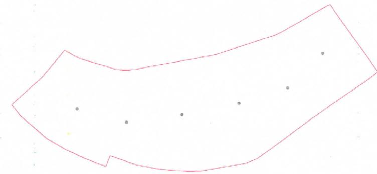
**Superficie utile 8: Illuminamento perpendicolare (adattivo) (Superficie)****Scena luce: Scena luce 1**Medio: 10.6 lx (Nominale:  $\geq 50.0$  lx), Min: 0.67 lx, Max: 24.6 lx, Min/Medio: 0.063, Min/Max: 0.027
