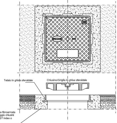
Muratura con malta fibrocarmata specifica per fissaggio chiusini tipo RESISTO FAST index o WEBER MC272
