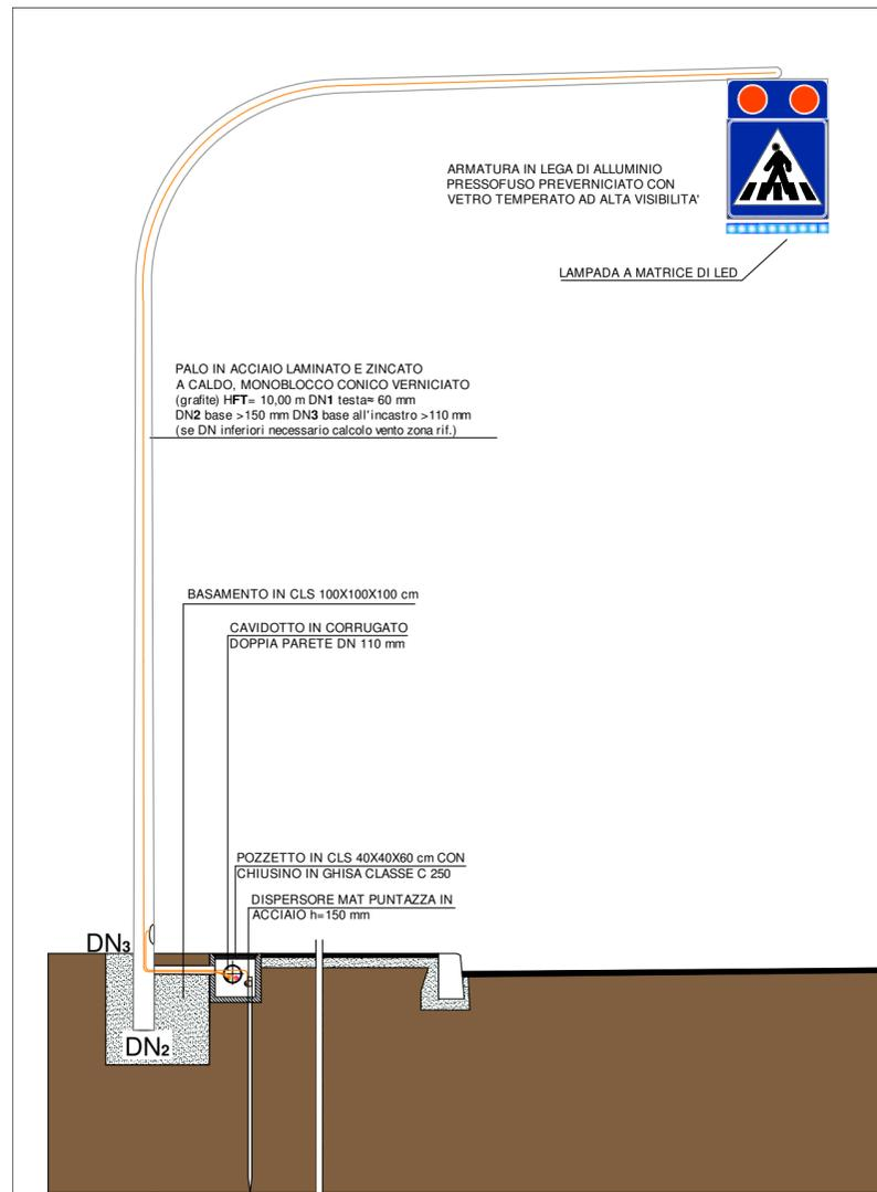
Particolare scavo per cavidotto impianto elettrico
