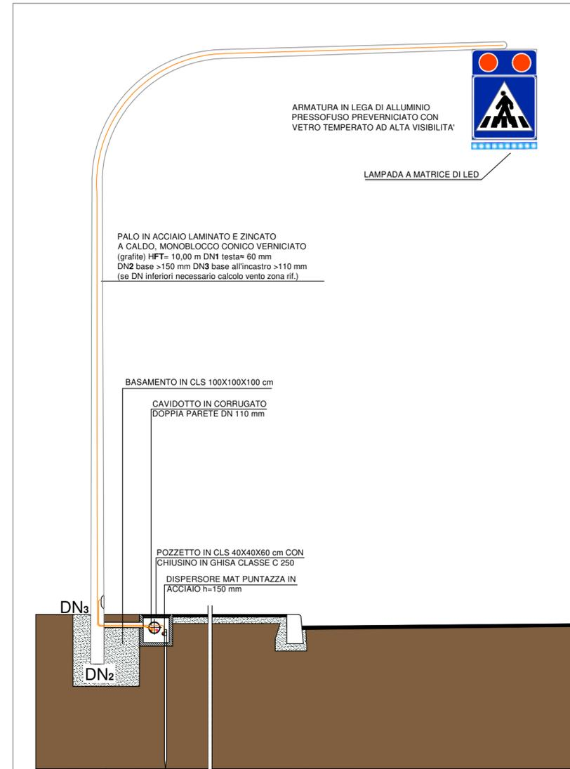
**Particolare scavo per cavidotto impianto elettrico**
