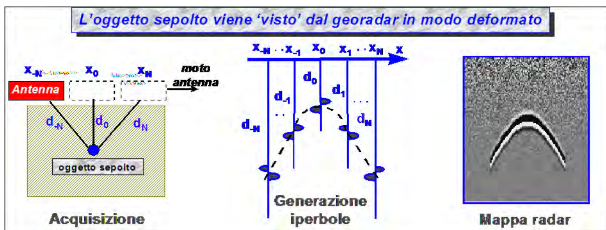
Figura 3-4: Principio di funzionamento del georadar
