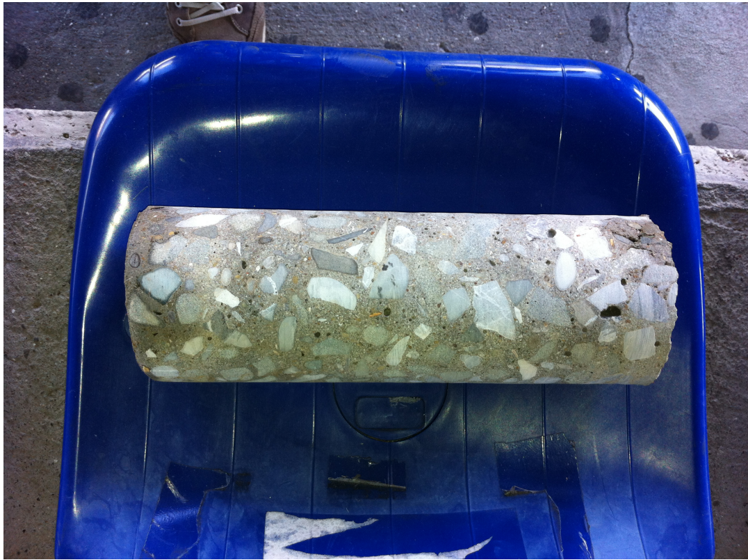
Carota eseguita sul pilastro interno piano terra del telaio 2 Corpo C.
