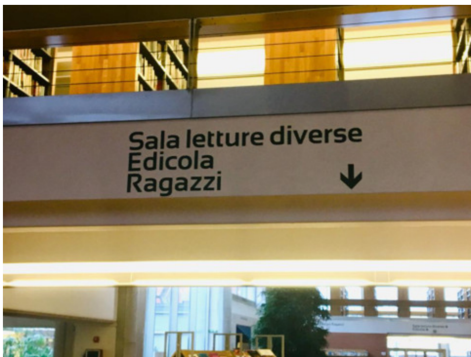
Fig. C-10) Esempi di segnaletica informativa strutturata in maniera eccellente in quanto contrasto tra caratteri e fondo, chiarezza e spaziatura del lettering e organizzazione delle informazioni in colonna in grado di favorire la lettura da parte di persone con campo visivo ristretto.
