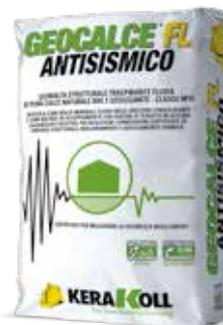
**Geomalta® strutturale traspirante fluida di pura calce naturale NHL e Geogelante® – Classe M15. Specifica come malta minerale fluida nelle iniezioni consolidanti e come matrice in accoppiamento con diatoni di tessuto in acciaio galvanizzato GeoSteel per realizzare connessioni certificate di rinforzo strutturale, miglioramento e adeguamento sismico. Certificato per migliorare la sicurezza degli edifici.**
