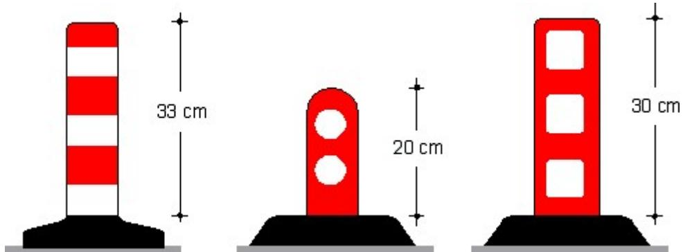
Gli elementi prefabbricati per salvagente pedonali e **delimitatori di corsia** possono essere realizzati in calcestruzzo, costituiti da sezioni componibili mediante appositi incastri. Essi devono essere impiegati solo nelle zone urbane per la creazione di isole pedonali di rifugio ovvero piattaforme di carico.
