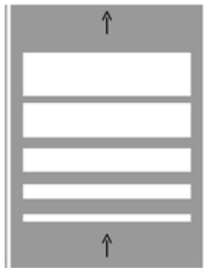
Sulla base delle indicazioni progettuali ovvero della Direzione Lavori, i sistemi di rallentamento ad **effetto acustico** saranno realizzati mediante irruvidimento della pavimentazione stradale ottenuta con la scarificazione o incisione superficiale della stessa o con l'applicazione di strati sottili di materiale in rilievo in aderenza, eventualmente integrato con dispositivi rifrangenti. Tali dispositivi possono anche determinare effetti vibratorii di limitata intensità.
