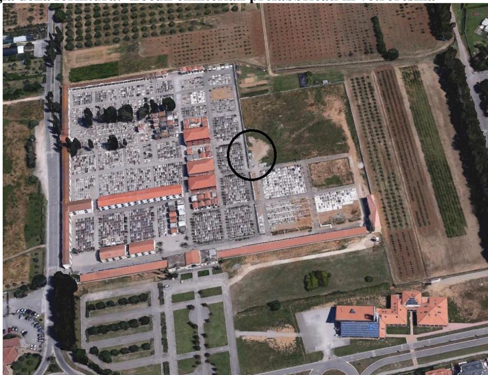
L'appalto prevede l'incremento della dotazione di loculi cimiteriali all'interno del cimitero comunale, mediante la realizzazione di un nuovo blocco costituito da un blocco in adiacenza al muro che divideva la parte originaria del cimitero dall'ampliamento degli anni 2000. Il nuovo ampliamento sarà costituito da un blocco prefabbricati con 128 loculi disposti su 32 colonne e 4 file di altezza . Sui due lati corti è prevista la messa in opera di n.35 ossari ciascuno.
