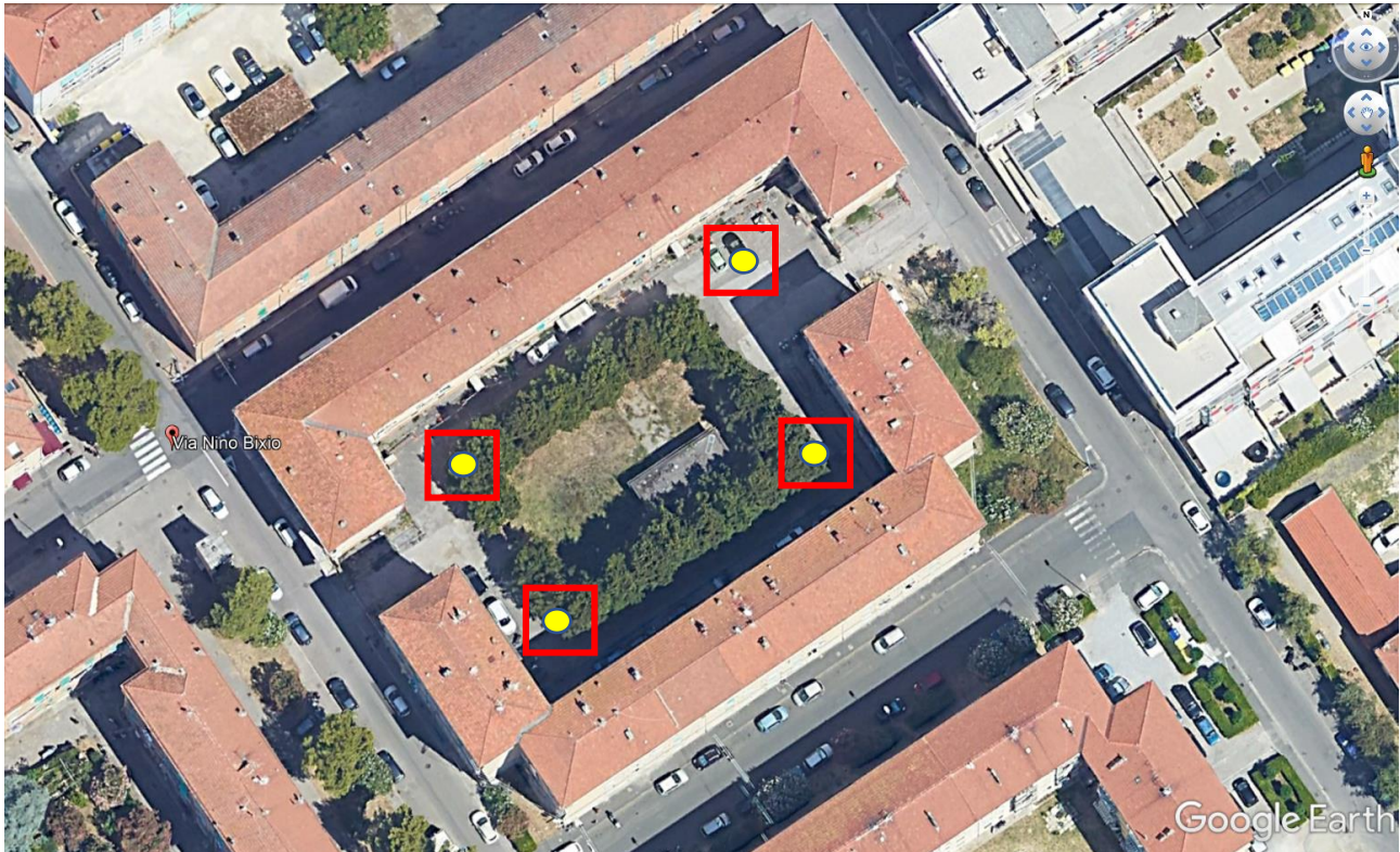
Schema delle indagini georadar su aree quadrate e dei relativi sondaggi (non in scala)
