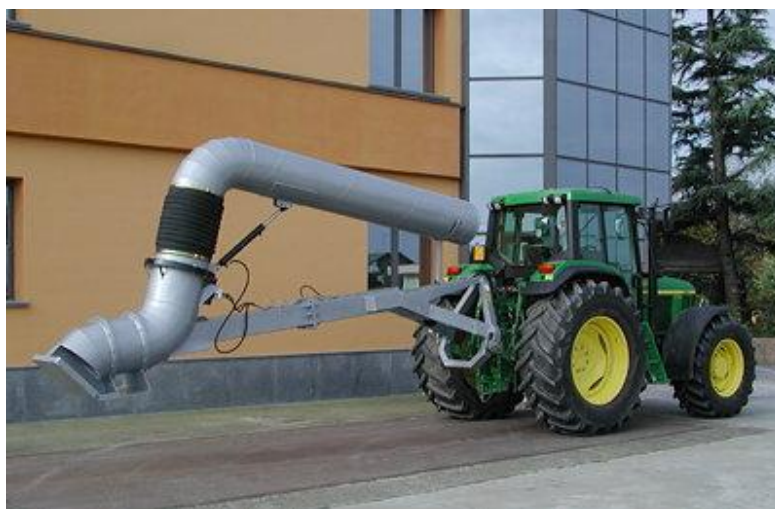
Foto 32 - vista di pompa mobile a cardano tipo Veneroni
