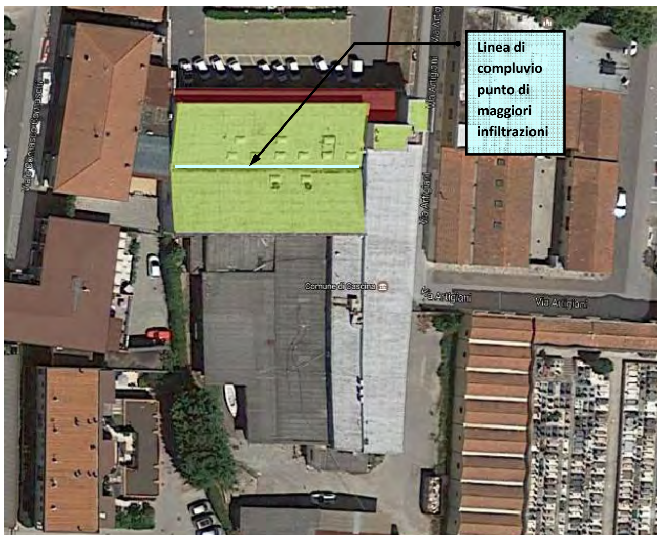
Zone di intervento: in verde le lastre in cemento amianto – in rosso copertura piana con membrana impermeabile
