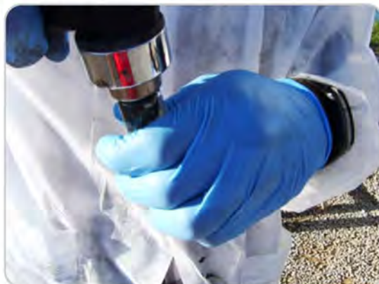
Immagine DFAP_16: Chiusura delle vials per l'analisi dei composti volatili mediante HS-GC
