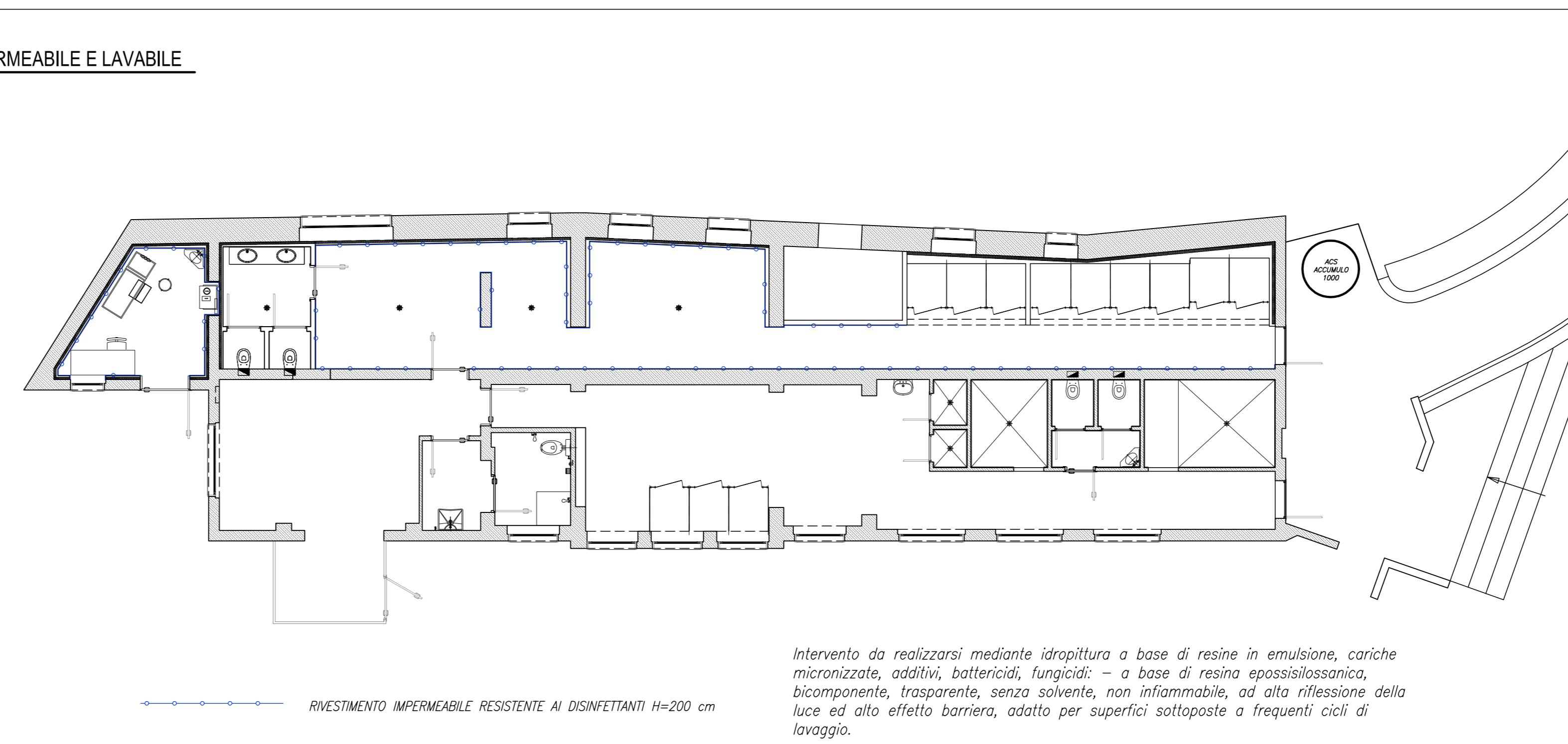
Intervento da realizzarsi mediante idropittura a base di resine in emulsione, cariche micronizzate, additivi, battericidi, fungicidi: - a base di resina epossidossanica, bicomponente, traspirante, senza solvente, non infiammabile, ad alta riflessione della luce ed alto effetto barriera, adatto per superfici sottoposte a frequenti cicli di lavaggio.
