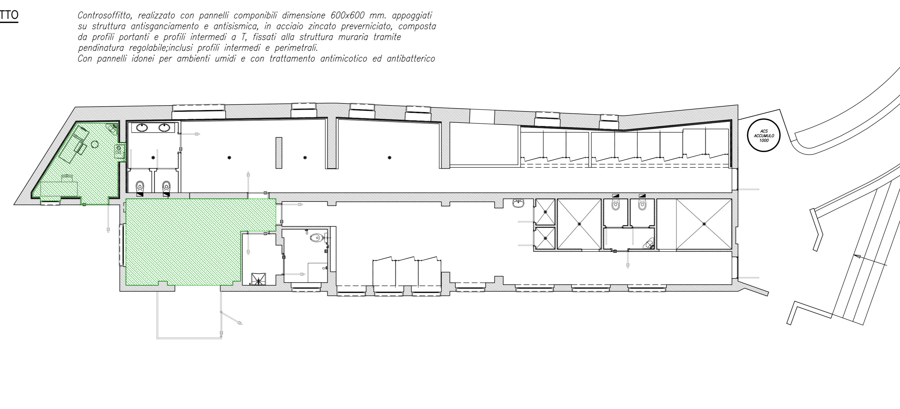
Controsoffitto, realizzato con pannelli componibili dimensione 600x600 mm. appoggiate su struttura antisognacimento e antisismica, in acciaio zincato preverniciato, composta da profili partenti e profili intermedi a T, fissati alla struttura muraria tramite penduratura regolabile/inclusi profili intermedi e perimetrali. Con pannelli idonei per ambienti umidi e con trattamento antimicotico ed antibatterico
