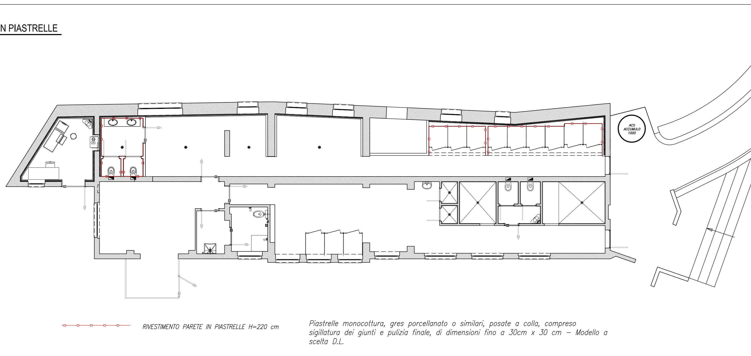
Piastrelle monocottura, gres porcellanato o similari, posate a colla, compresa sigillatura dei giunti e pulizia finale, di dimensioni fino a 30cm x 30 cm - Modello a scelta D.L.
