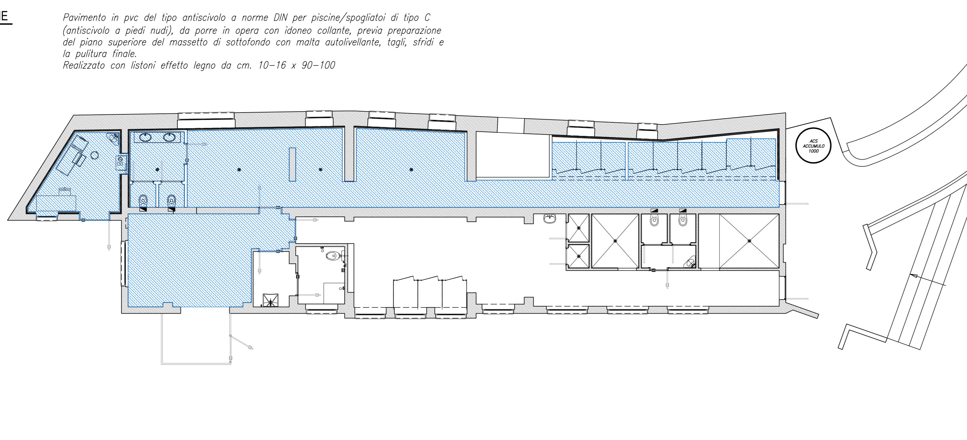
Pavimento in pvc del tipo antiscivolo a norme DIN per piscine/spogliatoi di tipo C (antiscivolo a piedi nudi), da posare in opera con idoneo collante, previa preparazione del piano superiore del massetto di sottosuolo con malta autolivellante, tagli, stridi e la pulitura finale. Realizzato con listoni effetto legno da cm. 10-16 x 90-100
