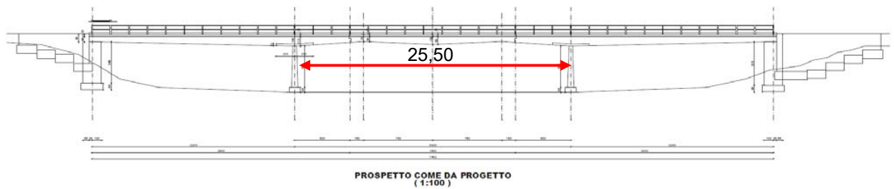
Figura 1- Sviluppo longitudinale del ponte Catolfi – Progetto originario
