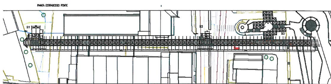
Fig. 1.2 Planimetria del ponte con indicati gli appoggi in S1, S2 e S3
